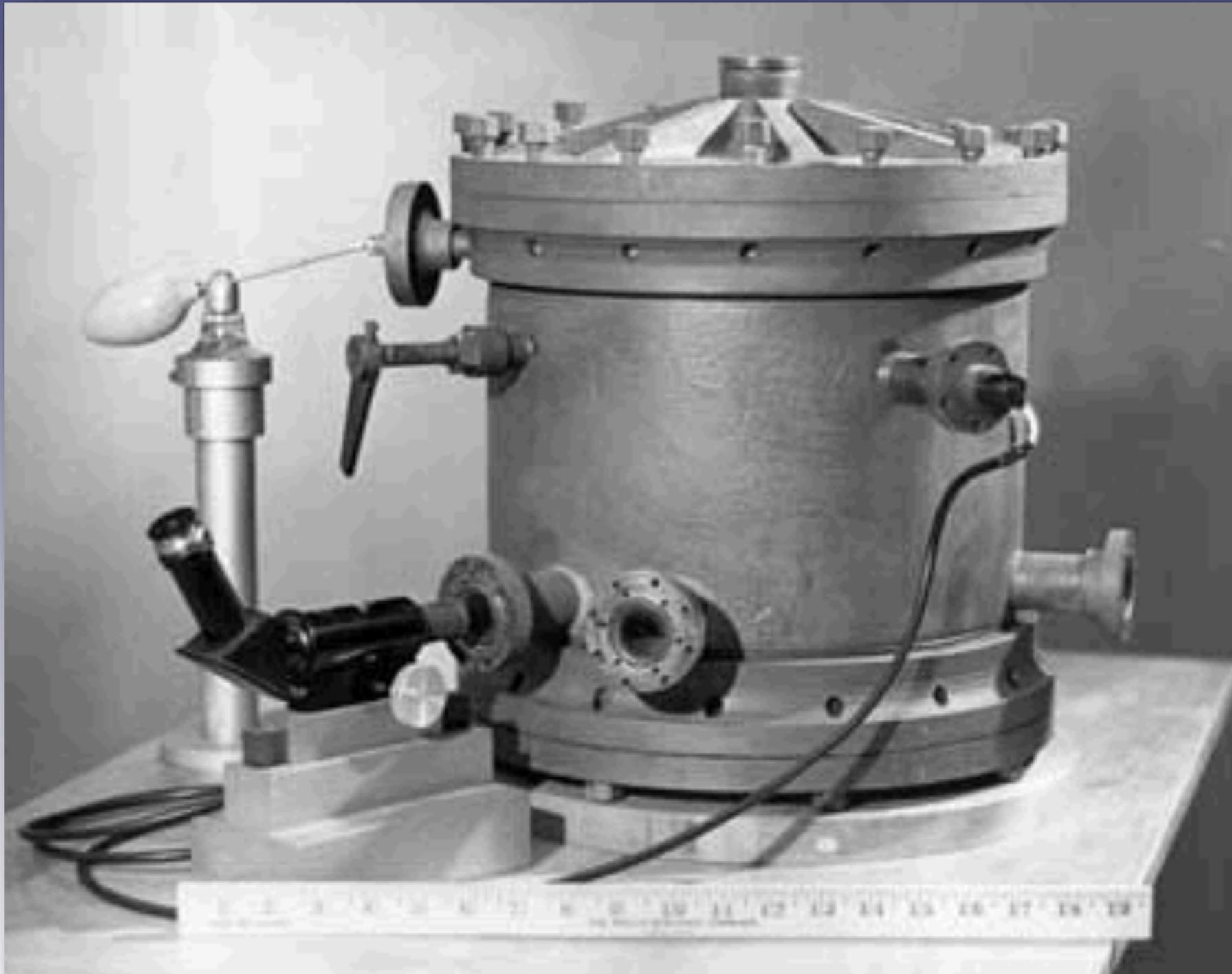
Experimento de Millikan para determinação da carga elementar do elétron.
